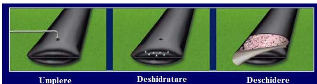
Figura 1. Principiul de deshidratare în Geotube
